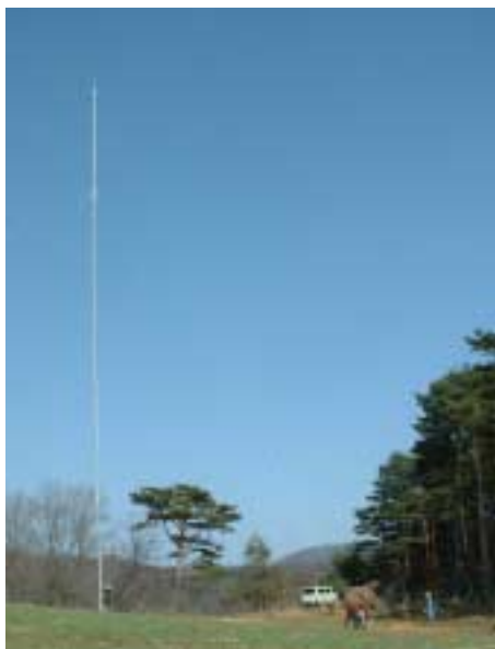
設置完了した高さ40mの風速計
